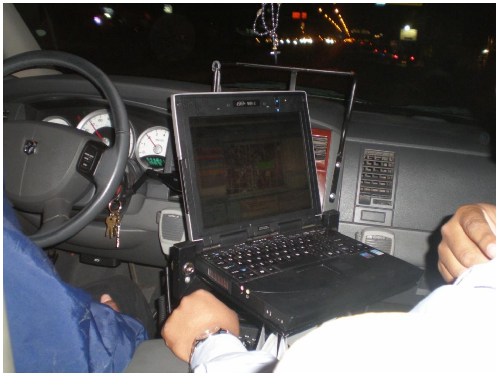
Imagen 28. Sistema móvil de cartografía operando en una patrulla.
